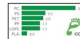
kg CO<sub>2</sub>-equivalent per kg polymer
